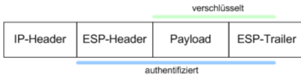
Abbildung 3: Aufbau eines ESP gesicherten Paketes
