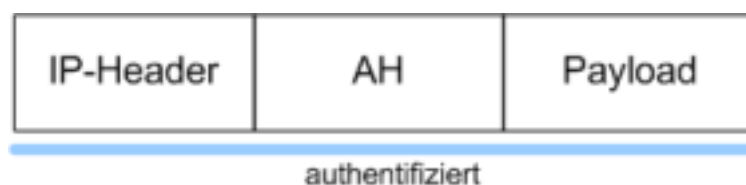
Abbildung 4: Aufbau eines AH gesicherten Paketes
